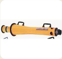
قاذف رغوة عادي التممد (٥x) تدفق (٢٢٥ لتر/دقيقة)
