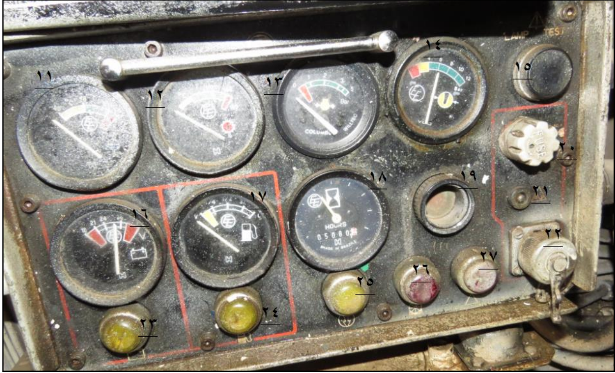
الشكل رقم (٢) يبين اللوحة المراقبة الرئيسية في غرفة السائق
